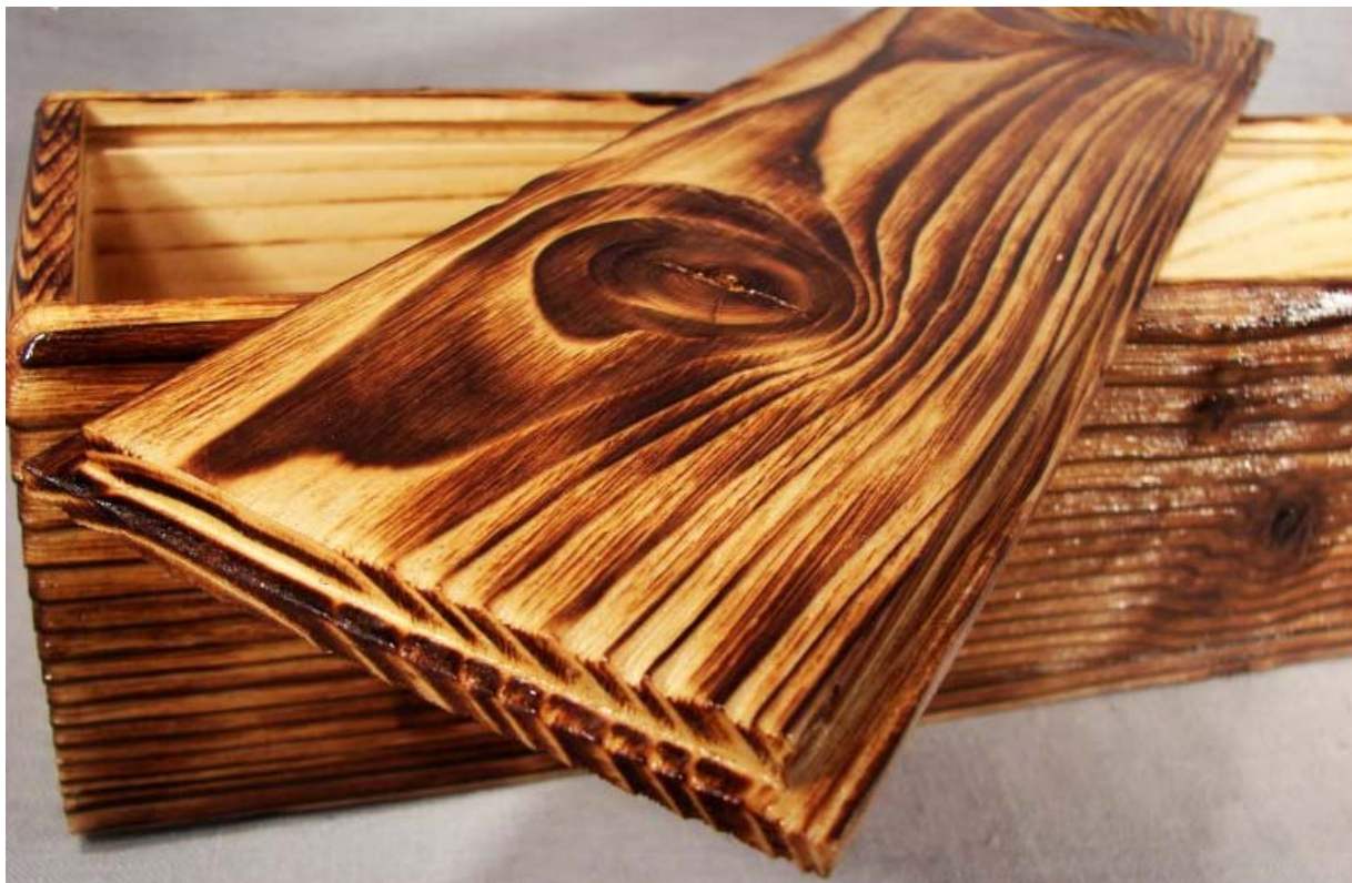
Рисунок 100 – Брашированная обжигом сосна ( http://proftula.ru )
