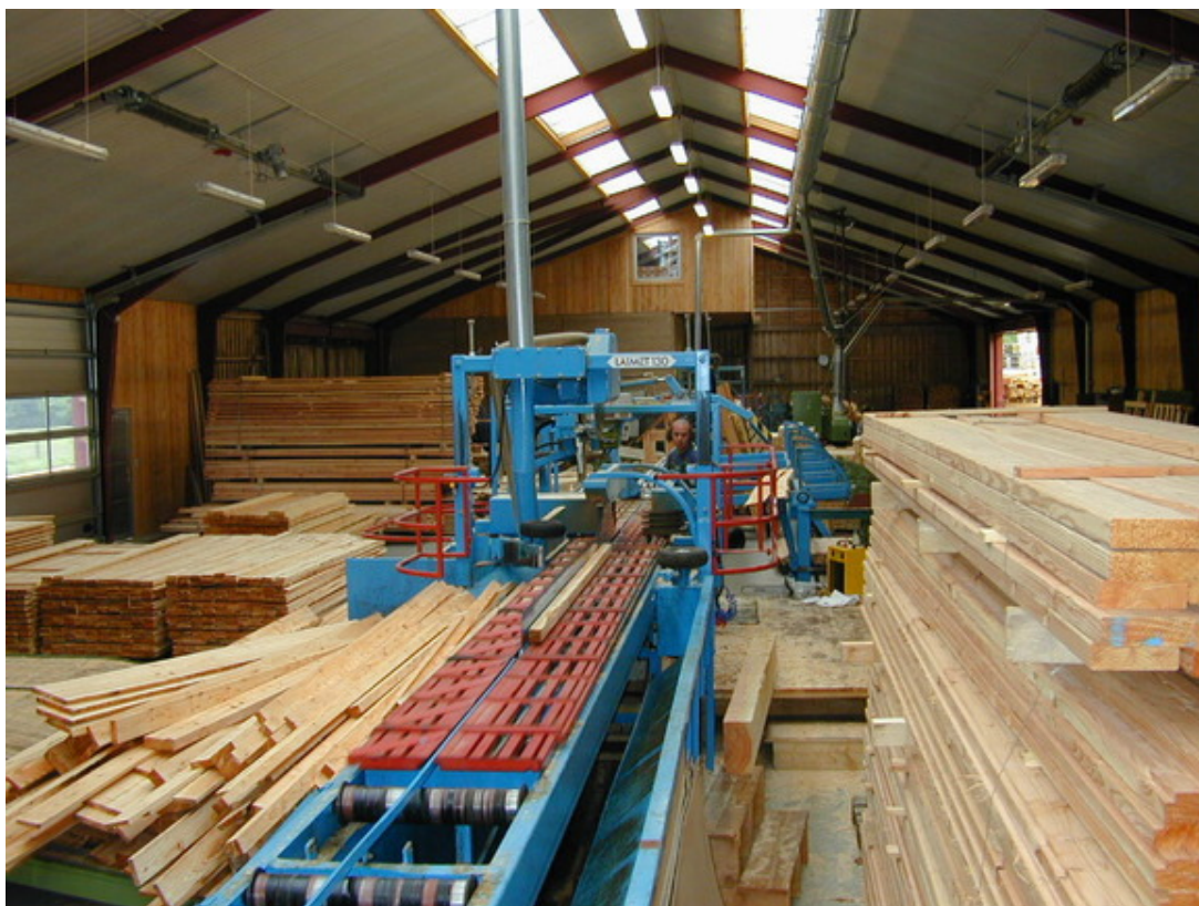
Рисунок 59 – Цех пилорамы с дисковой пилой ( http://yandex.ru/images/search?text-pilorama )
